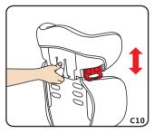
步骤九:根据孩子身高调节头靠高低以控制安全带的路径高低,避免因为头靠太高或太低而使安全带勒住孩子的脖子(C10、C11)。
