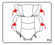
步骤四:转至座椅正面,将布套从 座椅正面卸除。
