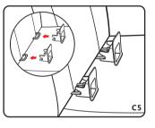
步骤四:将两个ISOFIT安装导向件 对准钢性固定点后插入。
