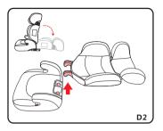
步骤二:将座椅靠背向后推倒,使 靠背与底座分离。
