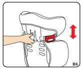
步骤五:根据孩子身高调节头靠高 低以控制安全带的路径高低,避免 因为头靠太高或太低而使安全带勒 住孩子的脖子(B6、B7)。
