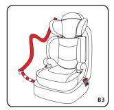
步骤二:将安全座椅前向放置在汽车后 排座位上。
