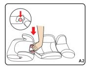
步骤一:将靠背弯钩与底座卡槽连接到位(A1,A2)。
