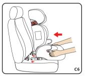
步骤五:将安全座椅底座的两个 ISOFIT接口对准ISOFIT安装导向件, 用力向前推动座椅直到完全卡入。
