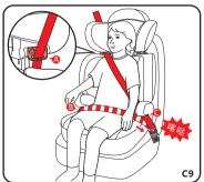
步骤八:将安全带如图穿过 A,B,C三个路径后锁定。
