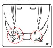
步骤一:将座椅后侧的两个钉扣打开
