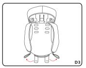
步骤三:将布套的橡筋从座椅中退出。
